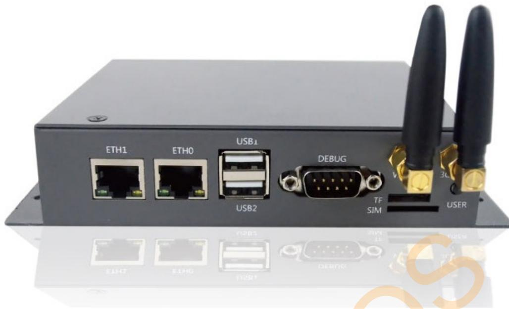
Hekr Gateway204型工业网关共有2个网口。ETH1作为外网网口接入路由器或者交换机，ETH0作为内网网口常用于网关配置，首次使用网关建议PC机与ETH0直连进行参数配置。
